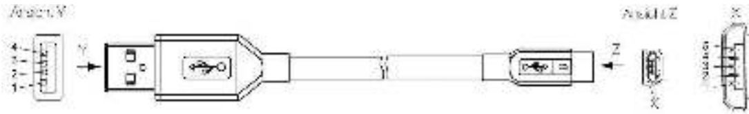
Bild 32: USB-Stecker Standard-A auf Stecker Micro-B (Kontaktbild „X“ vergrößert dargestellt)
